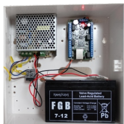
kontroler śluzy DS-2440S w obudowie metalowej z zasilaczem i akumulatorem 7 Ah
