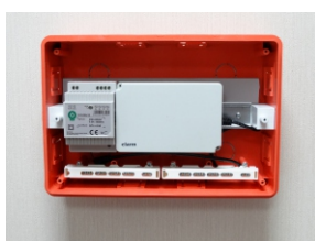
kontroler śluzy DS-2440S w obudowie na szynę DIN z zasilaczem 12V 2,5A
